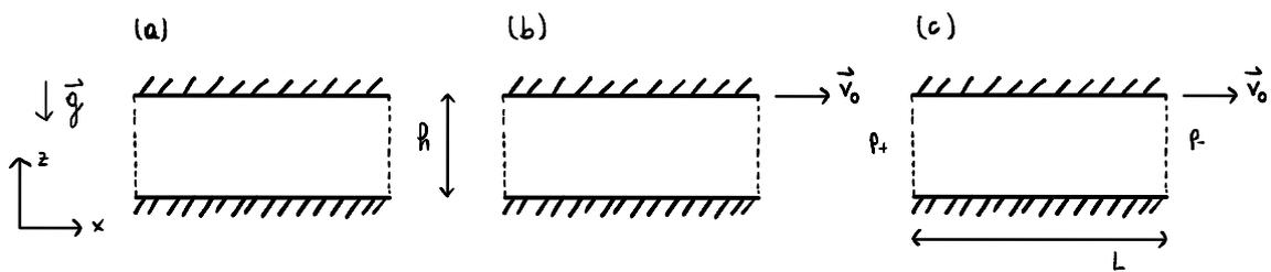
Abbildung 1: Hydrostatik, Couette- und Hagen-Poiseuille-Strömungen.
