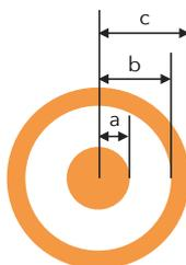
Ein Gleichstrom  $I$  fließe durch den inneren Leiter in eine Richtung und durch den äußeren Leiter zurück. Zwischen den beiden Leitern bestehe eine konstante Spannung  $U_0$ , die durch einen Verbraucher (z.B. einen Widerstand) am Ende der Leitung hervorgerufen wird. Der ohmsche Widerstand der Leitung kann vernachlässigt werden.
