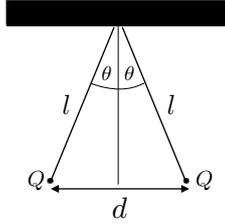
Wenn beide Körper mit der gleichen Ladung  $Q$  aufgeladen werden, stoßen sich die Körper ab. Berechnen Sie den Winkel  $\theta$ , unter dem sich dabei das mechanische Gleichgewicht einstellt. Hinweis: Verwenden Sie die Cardanische Formel um die Nullstellen der auftretenden kubischen Gleichung zu bestimmen.
