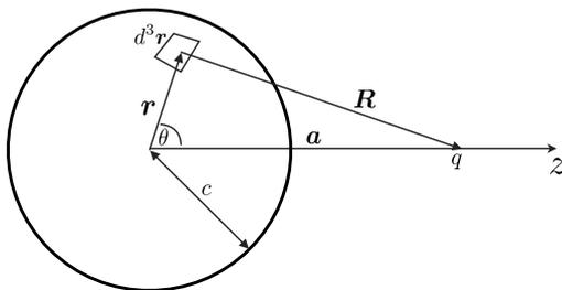
(i) Geben Sie formal das infinitesimale Kraftelement  $d\mathbf{F}$  an, welches von der Ladung  $dQ = \rho(\mathbf{r})d^3r$  in einem Volumenelement  $d^3r$  der Kugel auf  $q$  ausgeübt wird, wobei  $\rho(\mathbf{r})$  die Ladungsdichte der Kugel bezeichnet.
