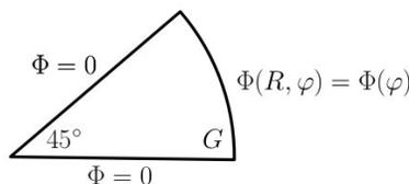
Gegeben sei das ladungsfreie Gebiet  $G$  wie oben gezeichnet. Auf den beiden Schenkeln bei  $\varphi = 0$  und  $\varphi = \pi/4$  sei  $\Phi = 0$ , auf dem Kreisbogen gelte  $\Phi(R, \varphi) = \Phi(\varphi)$ . Berechnen Sie das Potential im Gebiet  $G$  mit Hilfe eines Separationsansatzes.
