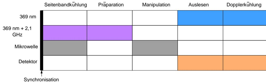
**Abbildung 4.3.:** Schematische Darstellung einer Messsequenz. Jede Sequenz wird zu Beginn mit den 50 Hz der Netzspannung synchronisiert. Eine farbige Füllung der Rechtecke symbolisiert eine Aktivität des entsprechenden Gerätes während des entsprechenden Schrittes in der Messsequenz. Siehe den Text für weitere Erläuterungen.
