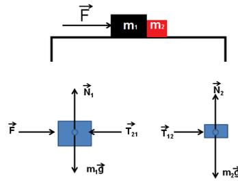
Abbildung 1: Eine Kraft wirkt auf den ersten Block, welcher einen anderen Block mit anderer Masse anschiebt.
