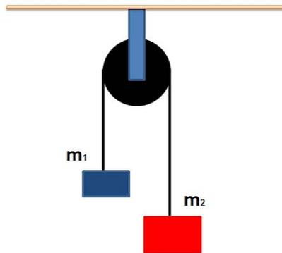
Abbildung 1: Zwei Massen, die über Umlenkrolle verbunden sind
