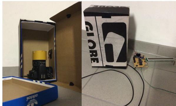
**Abbildung 1 a und b:** Versuchsaufbau zum Erstellen der Flatfields innen (a) und außen (b)
