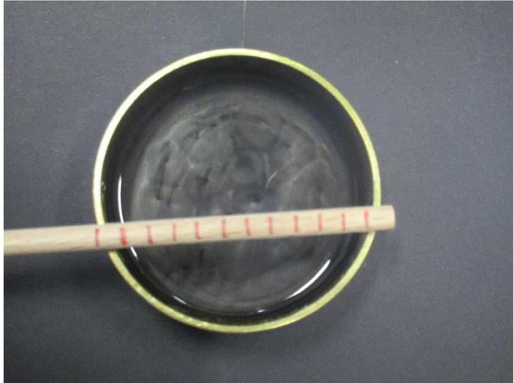
**Abbildung 6: Vermessung der Rayleigh-Bénard Zellen (Abstände in 0,5 cm Schritten)**
