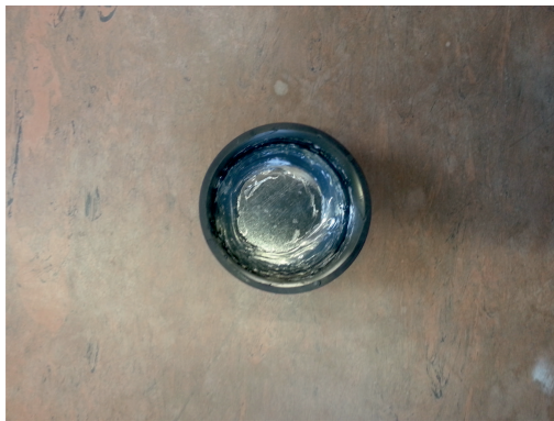
Abbildung 12: Der im Deckel aufgetragene Kleber von innen (links) und von außen (rechts)
