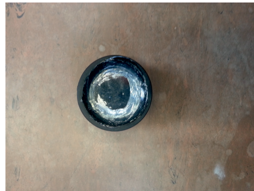
Abbildung 12: Der im Deckel aufgetragene Kleber von innen (links) und von außen (rechts)
