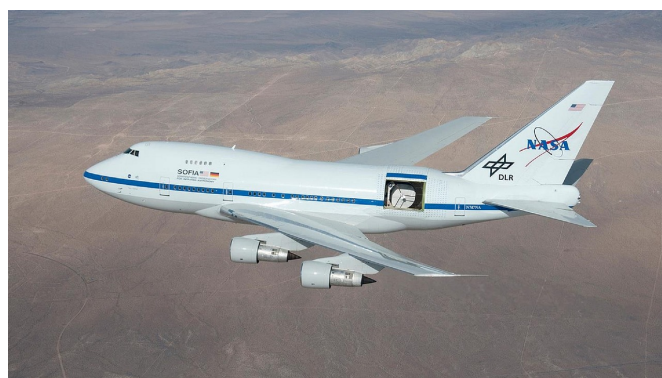
Abbildung 6: SOFIA, eine umgebaute Boeing 747SP mit Infrarotteleskop (CC0)
